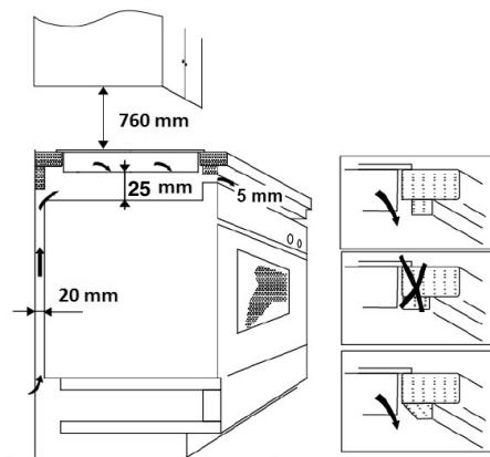
8. Ja plīts virsmas atrodas virs virtuves atvilktnes, starp atvilktnes saturu un plīti jābūt attālumam vismaz 50 mm.
