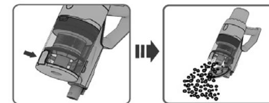
**DESMONTAR EL COLECTOR DE POLVO**
