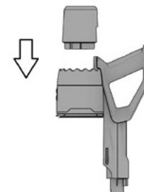
**Nota:** Para prolongar la vida útil de la batería, cárguela cuando esté casi agotada. No cargue o guarde el artefacto en lugares con temperaturas por debajo de 0°C o superiores a 40°C ya que podría dañarse. Durante la carga, la temperatura del artefacto podría aumentar. Se trata de un fenómeno normal.
