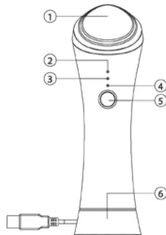
Notă: Acest aparat are încorporată baterie cu litiu și se poate încărca doar cu ajutorul cablului USB care face parte din livrare.
